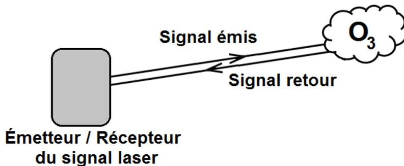
Le signal met  $3 \mu s$  pour aller jusqu'à la zone analysée et revenir au récepteur.
